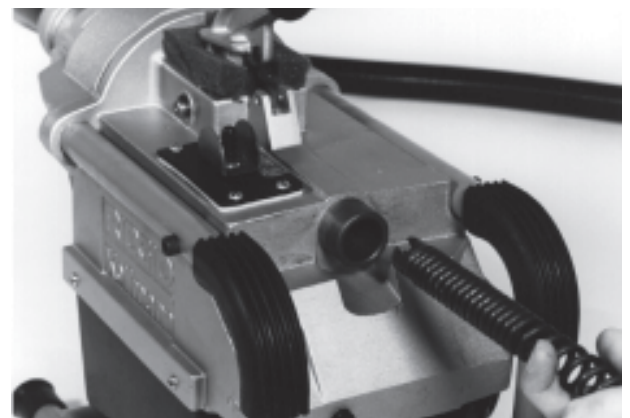
Figure 5 – Introduction du câble par l'avant de la machine
