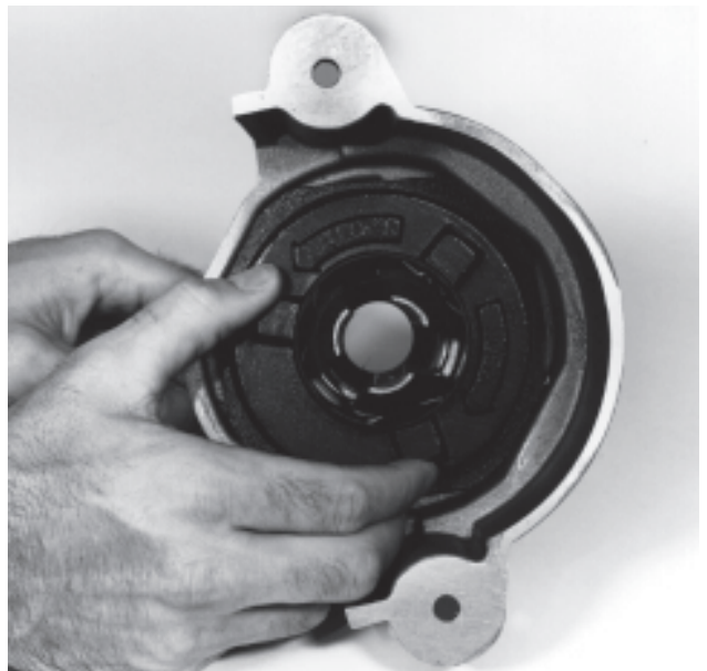
Figura 12 – Desmonte la tapa del juego de mordazas
