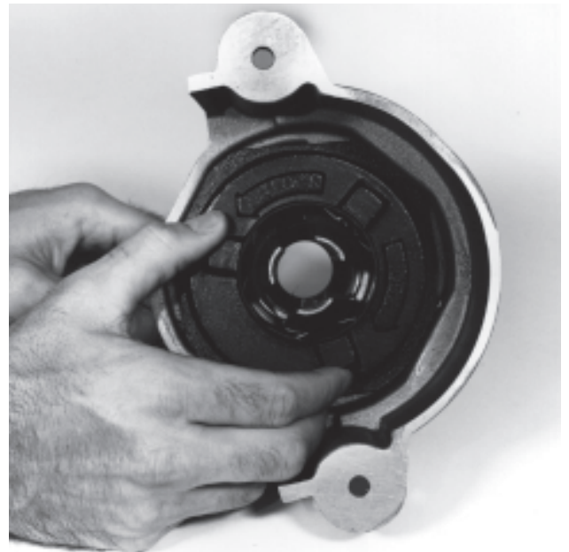
Figure 12 – Retrait du couvercle des mâchoires
