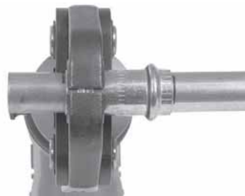
Figura 7 – Selladora RP 340 en posición perpendicular al tubo
