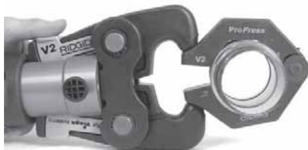
Figura 9 – Montaje del accionador en el aro sellador
