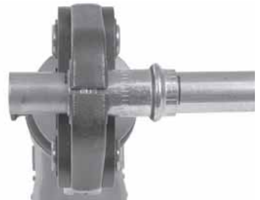
Figure 7 – RP 340 perpendiculaire au tube
