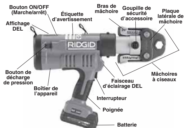
Figure 1 – Sertisseuse RP 340 et mâchoires
