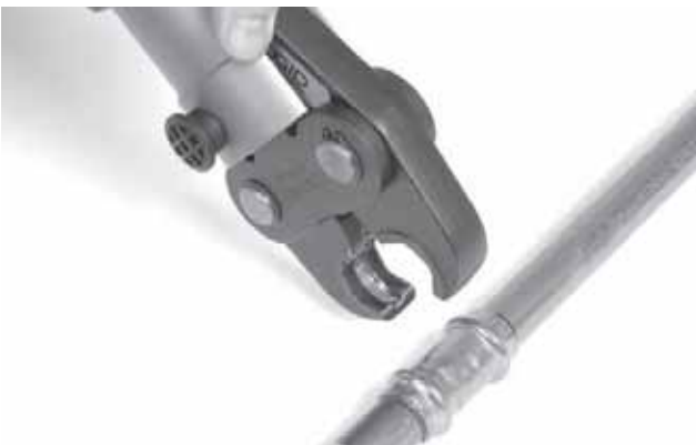
Figure 6 – Ouverture des mâchoires à ciseaux
