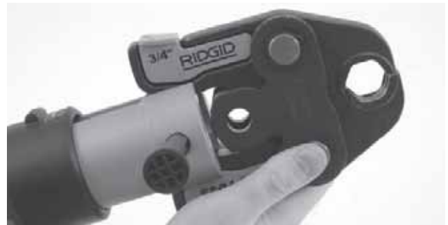
Figure 5 – Glissement de l'accessoire dans l'appareil
