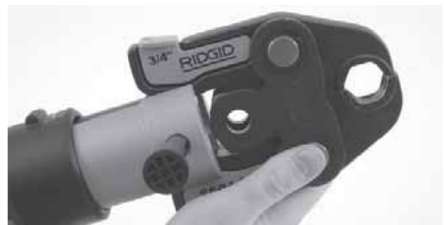
Figura 5 – Para montar el accesorio en la selladora, deslícelo sobre la nariz
