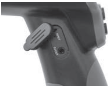
9. ábra - TV-OUT csatlakozó/Reset gomb
