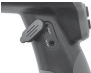
Slika 9 - TV-OUT utikač/taster Reset
