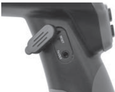
Slika 9 – Priključek TV-OUT/gumb Reset
