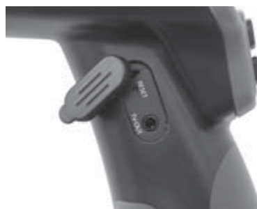
Рис. 9 - Гнездо выхода телевизионного сигнала TV-OUT/Кнопка сброса "Reset"
