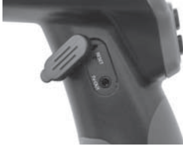
Şekil 9 - TV-ÇIKIŞ Jakı/Sıfırlama Düğmesi
