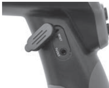
Εικόνα 9 - Jack TV-OUT/Κουμπί επανεκκίνησης (Reset)
