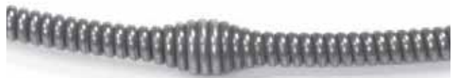
Figura 11 – Cable C-13-IC SB con “joroba” ubicada a aprox. 2,13 metros (84 pulgs.) de su término
