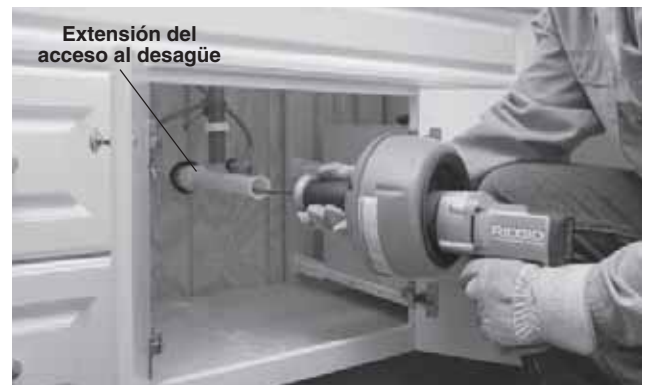
Figura 6 – Manera en que se alarga el desagüe para situar la nariz de la K-45 a menos de 15 cms. (6 pulgs.) del acceso
