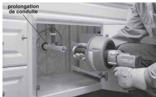
Figure 6 – Exemple d'un point d'accès prolongé permettant de respecter une distance maximale de 6" (15 cm) par rapport à la sortie du tambour
