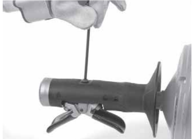
Figura 12A – Extracción del tornillo de la AUTOFEED
