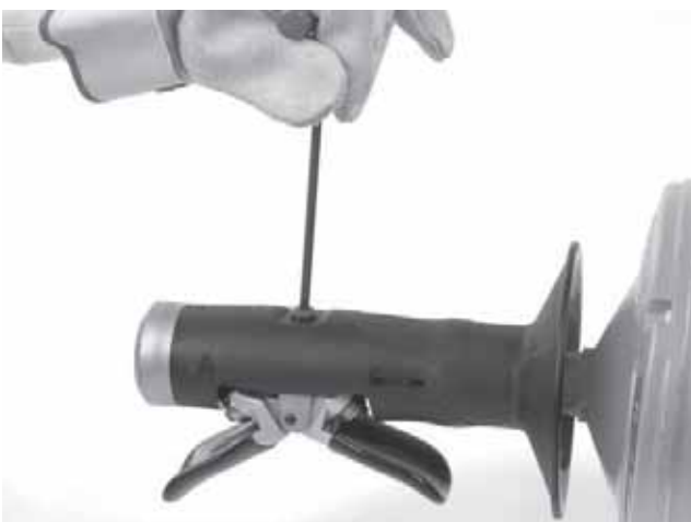
Figure 12A – Retrait de la vis de l'AUTOFEED
