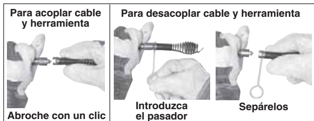
Figura 7 – Acoplamiento y desacoplamiento de herramientas en la punta del cable
