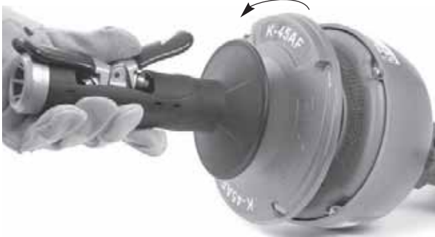
Figura 14 – Apertura de la tapa del tambor exterior
