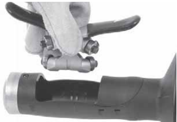
Figura 12B – Extracción del mecanismo de la AUTOFEED
