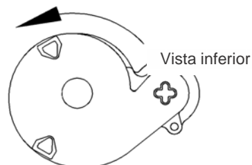
Fig. 1 – Rotación correcta del rotor, modelos trifásicos
