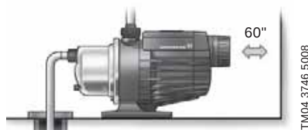
Fig. 3 Dégagement minimal derrière la pompe
